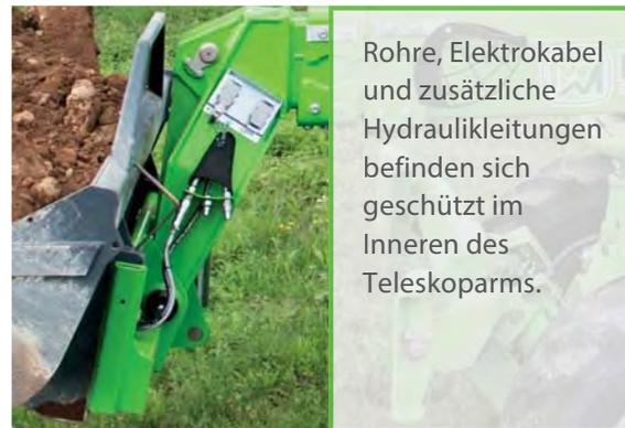
Rohre, Elektrokabel und zusätzliche Hydraulikleitungen befinden sich geschützt im Inneren des Teleskoparms.
