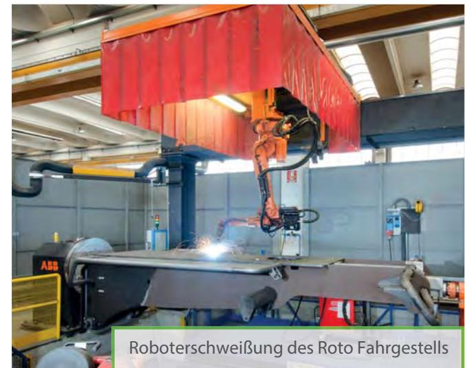
Roboterschweißung des Roto Fahrgestells
