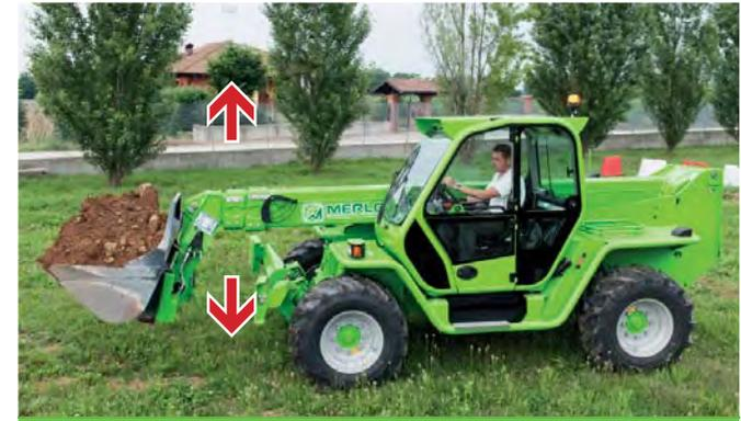
BSS hydropneumatische Schwingungsdämpfung am Arm (opt): zuschaltbar, beschleunigt Transporte, schützt die Ladung und verbessert die Produktivität
