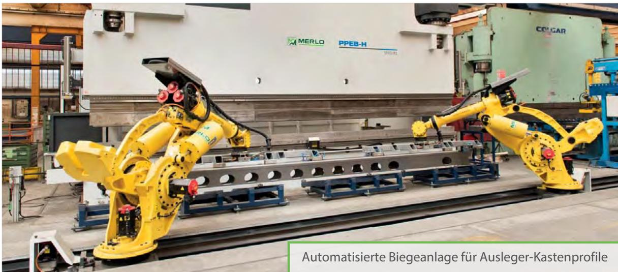
Automatisierte Biegeanlage für Ausleger-Kastenprofile
