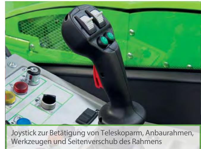
Joystick zur Betätigung von Teleskoparm, Anbaurahmen, Werkzeugen und Seitenvershub des Rahmens
